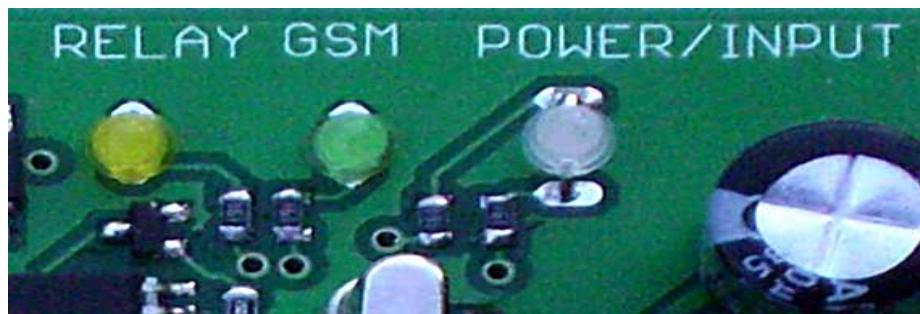
**POWER** - červená, trvalý svit indikuje připojení k napájení. Rychlé blikání 4x za sekundu svítí a pohasne, indikuje detekci alarmu při zapnutém hlídání – **ALARMZAP**.
